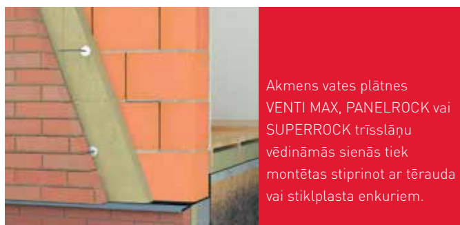
Akmens vates plātnes VENTI MAX F, PANLEROCK F tiek montētas starp vertikāliem tērauda elementiem stiprinot ar enkuriem..
